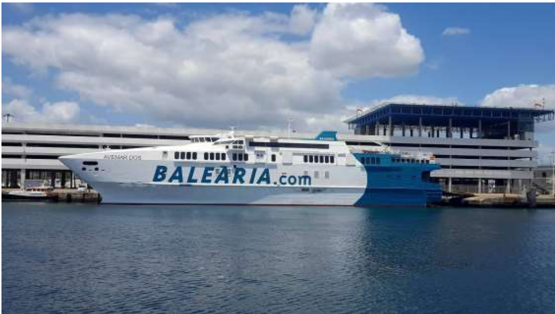
-Figura 8: HSC Avemar Dos (1997). 4 motores MTU 20V1163-TB73L de 9100 cv.
