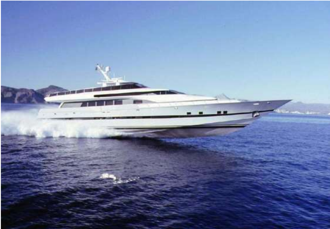
-Figura 9: Foners (2000). 3 motores Rolls-Royce Kamewa waterjets y 22660 cv.
